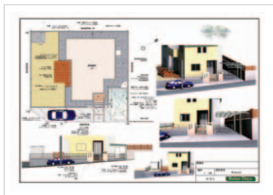
【門扉とカーポート】 門扉はカムフィ2型、フェンスはメッシュフェンス。カーポートはマリード。屋根の傾斜が前後なので隣家に雪が落ちる心配がなく、手前に柱のない片支持タイプなので、スペースが広く使えて車の出し入れが楽です。
