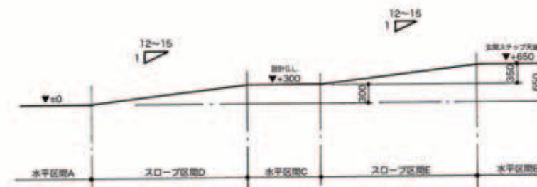
図-2 踏み場のあるスロープの断面図
