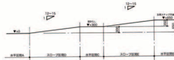
図-2 踊り場のあるスロープの断面図
