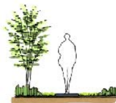
人が一人で歩く通路巾としては60 cm程度あれば良いがメイン通路としては狭い。
