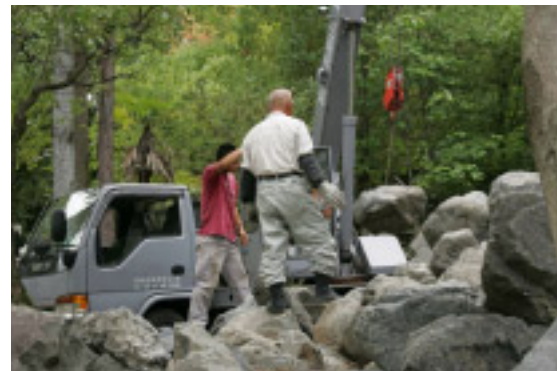
山積みされた石のなかから、クレーン車で、庭に使う石を選び分ける造園業者。こうして必要な石を選んで買い付けます。
