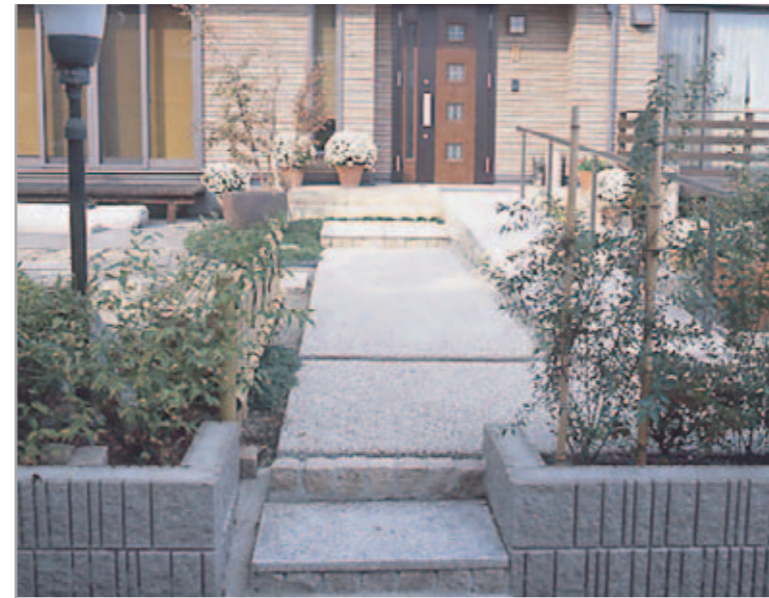
【スロープのアプローチ】玄関アプローチを境に、左側（奥）が和の庭、右側（手前）が洋の庭に分かれています。どちらのイメージにも合うように、アプローチの床には直線的な石を使って和の雰囲気をもたせています。また、段々と並んでスロープも設置。高齢のご両親のための暖かい配慮です。
