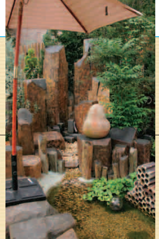
新素材の紹介も。発泡スチロールの表面をセメントで固め、着色した「アートワーク」という手法の二セ岩。軽くて施工がラクなのが特徴。
