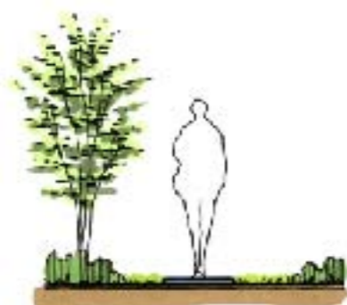
人が一人で歩く通路巾としては60 cm程度あれば良いがメイン通路としては狭い。
