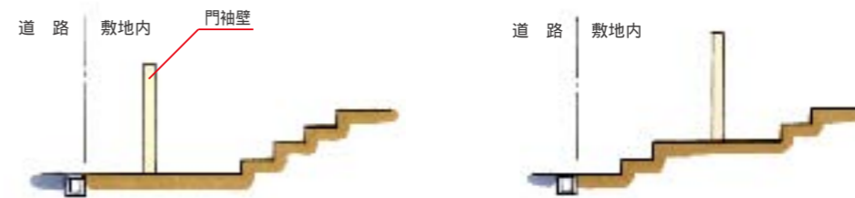
門を入ってから階段をとるパターンは道路に対して圧迫感を出さずにデザイン出来るが階段を上がりきるまで土留めが必要となる。
