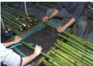
中川竹材店での作業風景。竹は使用する前にこうして洗い洗います。
